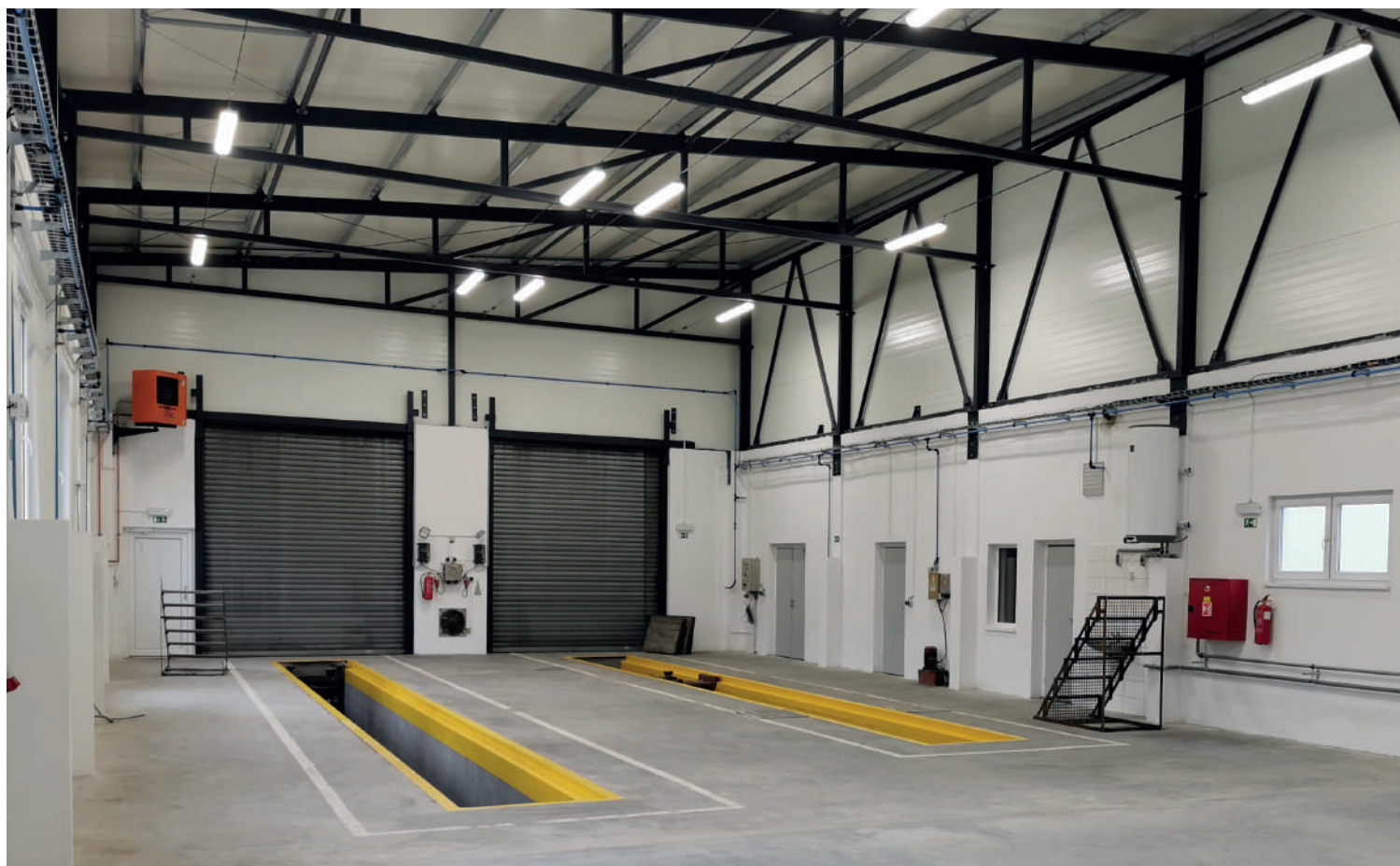
V průjezdné dílně lze najednou opravovat čtyři autobusy. Nově i s pomocí sloupových zvedáků.
